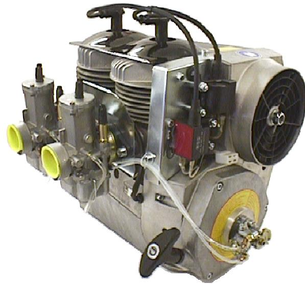
Der 2703 V ist ein luftgekühlter, kantengesteuerter 2-Zylinder-Reihen-2-Takt-motor mit einem oder zwei Vergasern und Nikasil beschichteten Zylindern. Er hat eines der niedrigsten Leistungsgewichte der auf dem 50 PS-Markt erhältlichen Motoren. Maßgeschneidert für den Antrieb von Ultraleichtflugzeugen, Hovercrafts, sehr leichten Experimentalflugzeugen und jeglicher Anwendung, bei der Gewicht eine maßgebliche Rolle spielt.
